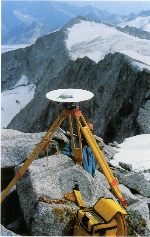
*Il GPS, un modernissimo strumento di misurazione basato sui satelliti è oggi utilizzato per le misurazioni sui ghiacciai trentini (foto R. Bombarda)*
